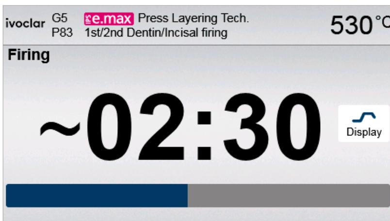
Le four est paramétré, au départ de l'usine, de façon à ce que le mode Courbe de cuisson soit automatiquement affiché au démarrage d'un programme.
