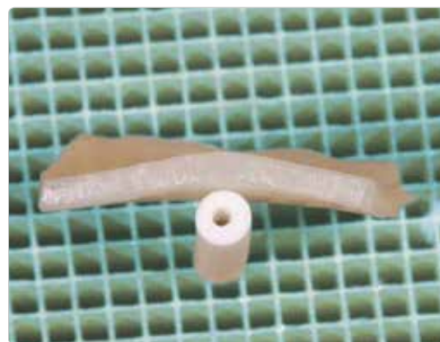
Céramique pressée conventionnelle en disilicate de lithium
