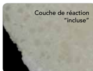
Céramique pressée conventionnelle disilicate de lithium
