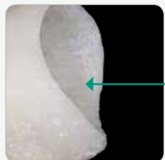
Couche de réaction : couche hybride de revêtement et matériau pressée
