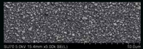
Eine einzigartige Füllertechnologie : 200 nm Strontium-Glaspartikel, homogen verteilt in der Matrix. SEM-Bild (2000 x)*
