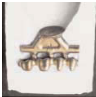
Sauberer Guss ohne Gussfahnen
