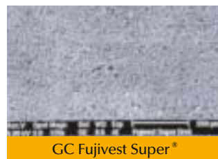
SEM-Aufnahme mit 125facher Vergrößerung der Einbettmassenoberfläche
