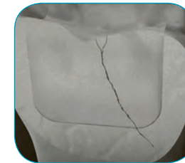
Herkömmliches Composite: Rissausbreitung durch die Füllung.
